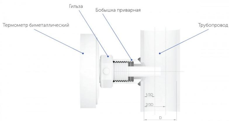
При необходимости установки термометра в ограниченном пространстве или на углах трубопроводов, возможно использовать скошенные под угол 45° приварные **косые бобышки** (№ 20, 21).
